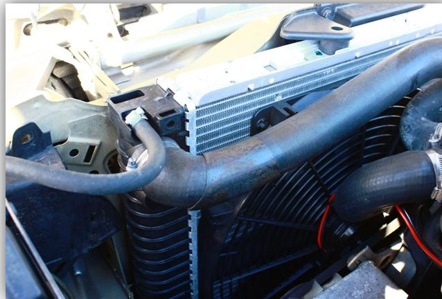
Figure 13: E30 Fan Placement.
